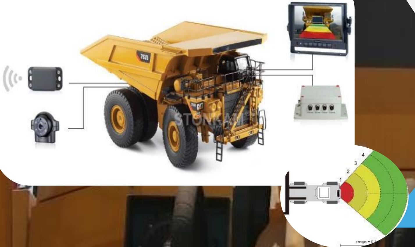
La finalidad de los sistemas de sensor por radar de microondas es detectar personas y objetos en puntos ciegos para reducir considerablemente los accidentes.
